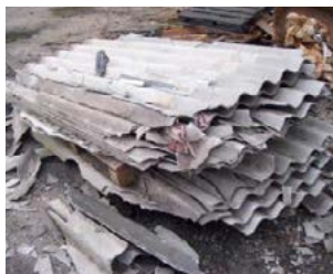
Figura 18 – Não conforme – Telhas partidas e sem embalagem.
