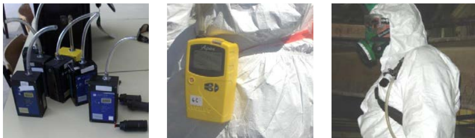
Figura 7 – Amostragem concentração das fibras de amianto (bomba, tubo e cassete).
