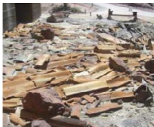
Figura 18 – Não conforme – Telhas partidas e sem embalagem.
