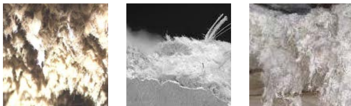
Figura 3 - Amianto em situação friável, que se desagrega e liberta facilmente.
