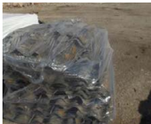
Figura 16 – Não conforme - Mal embalado, sem símbolo amianto aposto e escondido.
