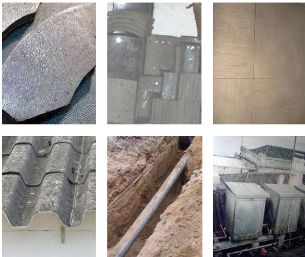
Figura 14 – Amianto não friável (calces, componentes metálicos, pavimentos vinílicos e fibrocimento em coberturas, condutas e depósitos).
