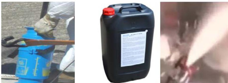
Figura 33 – Pulverizador para aplicação de aglutinantes de fibras de amianto.
