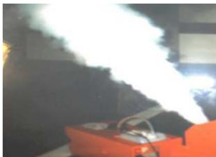
Figura 27 – Ensaios de fumo para verificação da estanquidade das zonas confinadas, em situações de amianto friável.
