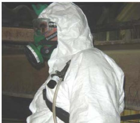
Figura 19 – Medição da concentração de fibras de amianto, no trabalhador.
