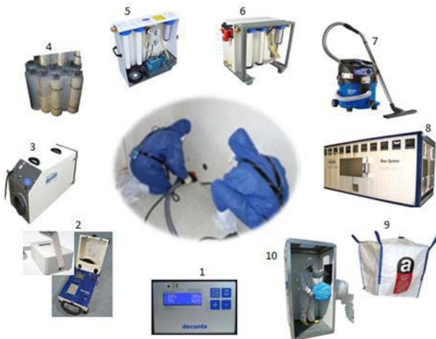
Figura 41 – Principais equipamentos de apoio utilizados na remoção de amianto friável.
