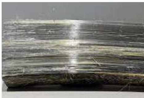
Figura 8 – Grunerite ou amosite, amianto do grupo das anfíbolas (fibras e rochas).
