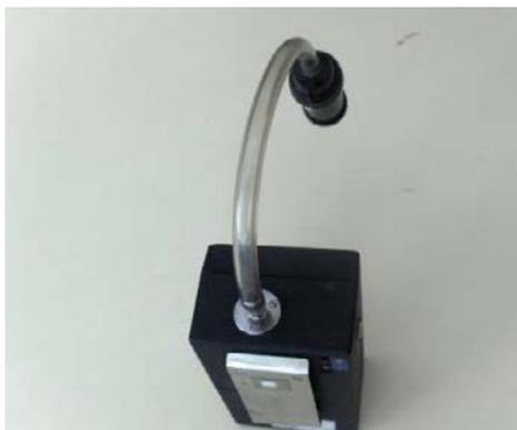
Figura 17 – Amostragem para amianto – bomba de colheita (bomba, tubo e cassete).
